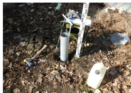
provedení vsakovací zkoušky
